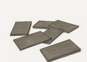
Accessoires de pose et d'ajustement : cales permettant la mise à niveau des caissons avant fixation à la paroi
